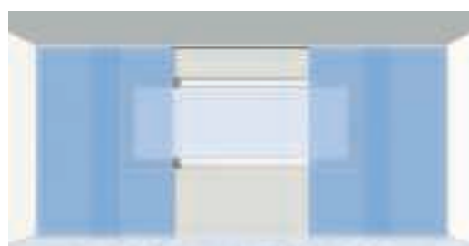
Beispiel: zweiläufige Anlage, Schnurbedienung, mit 4 Stoffpaneelen – Pakete getrennt
