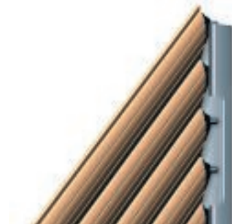
Stäbe hinterhaken in der Führungsschiene, Herausrutschen wird somit verhindert
